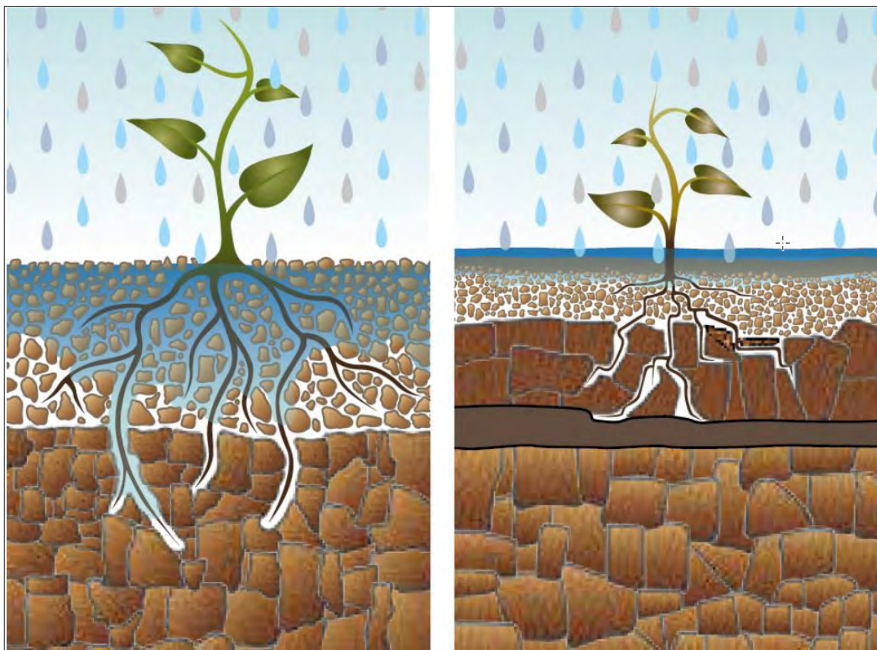
Figuur 2-2 Illustratie van het effect van vegetatie op de infiltratiecapaciteit van de bodem. Naar Forbes et al. (2015).
